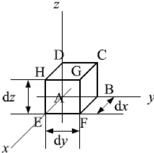
力を体積に比例する力（体積力）と境界面を通して働く力（応力）に分けて考える。
